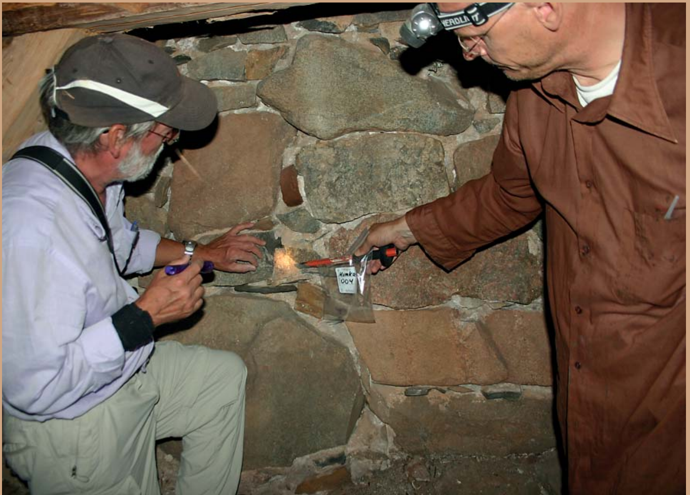
Jan Heinemeier og Alf Lindroos i færd med at udtage mørtelprøver til analyse fra Kumlinge kirke på Ålandsøerne.
